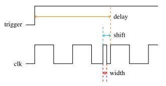
Fig. 1: Clock glitch parameters [8].
